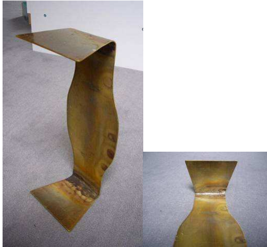
Verfärbungen des Blechs vom Weichglühen
